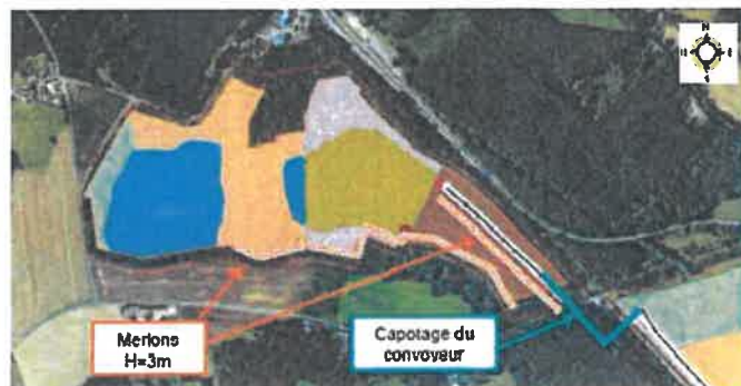
Dispositifs de protection en phase 3
