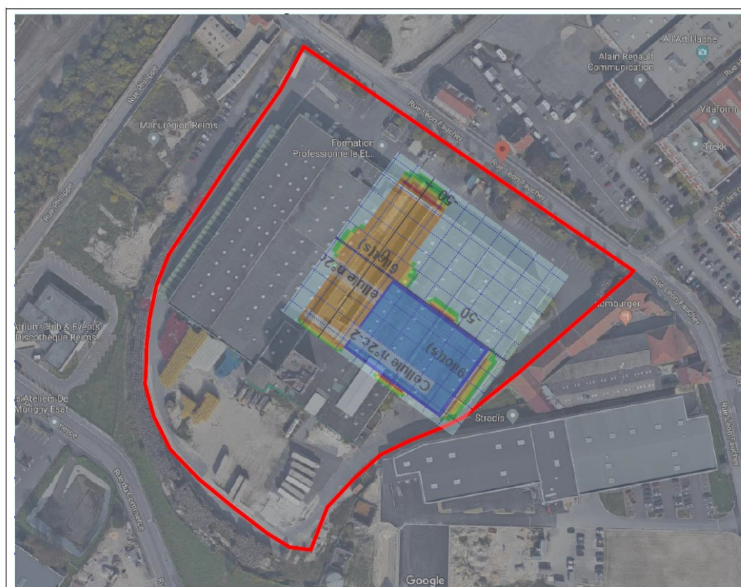
Scénario 4 – incendie de la cellule 2c
