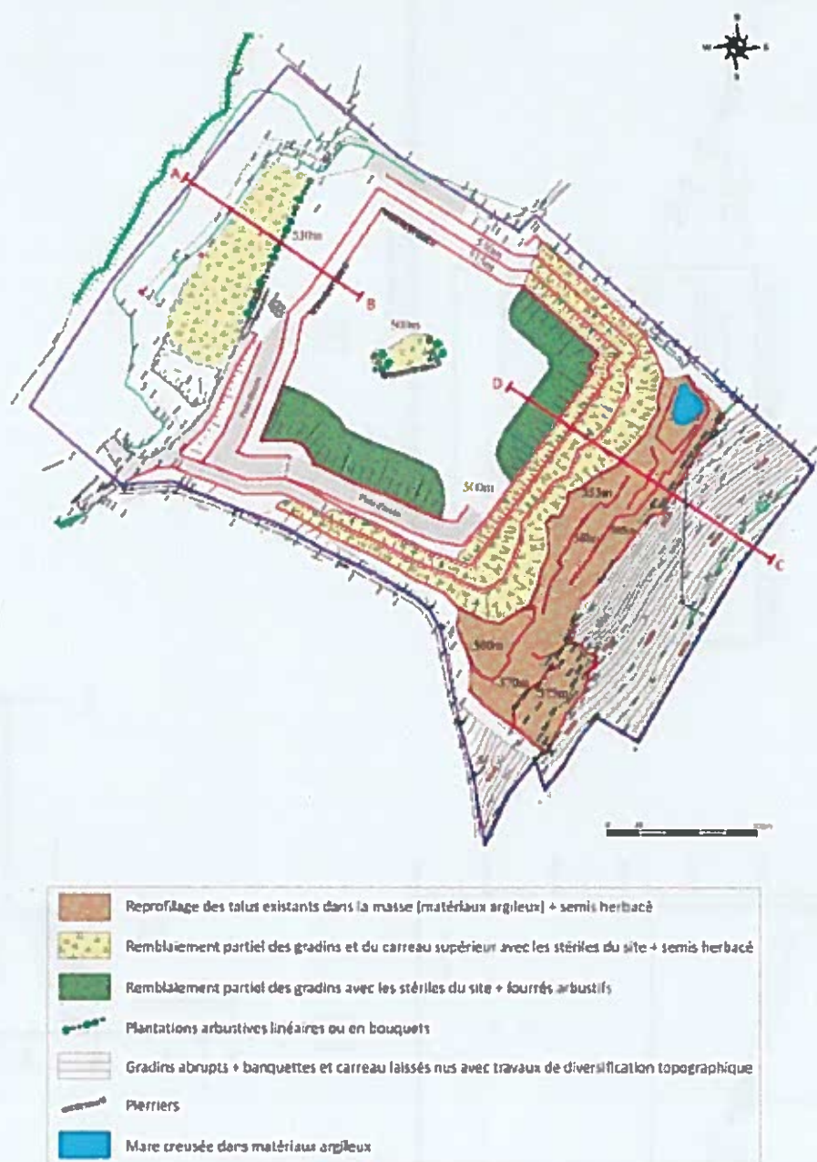
Figure 66 : Principes de la remise en état
