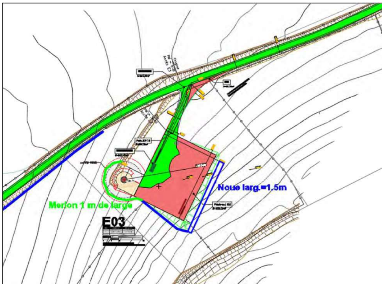
Aménagements hydrauliques Eolienne E03
