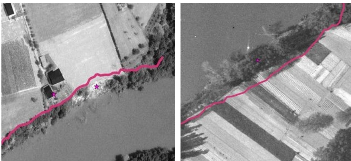
Figure 18: Exemples de comparaison entre des photographies aériennes anciennes et la position actuelle du sommet de berge (trait rose). A gauche évolution avec recul de de 7 à 8 m depuis 1978 à Castelnau-de-Lévis. A droite, évolution avec recul d'environ 10 m depuis 1947 à Coufouleux.
