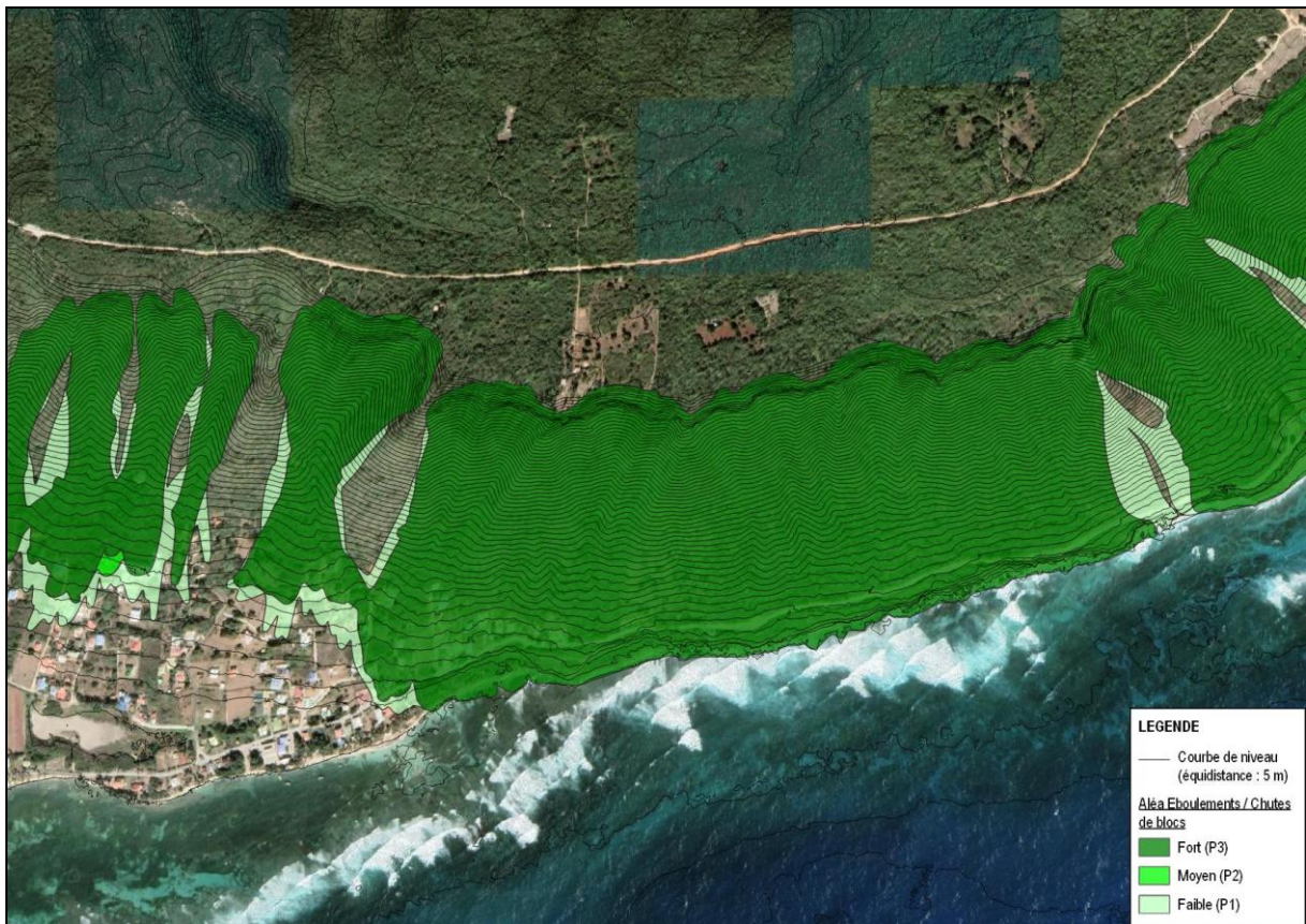
Figure 30 : Extrait de l'aléa Eboulements / Chutes de blocs finalisé sur La Désirade [Source : Ginger CEBTP]
