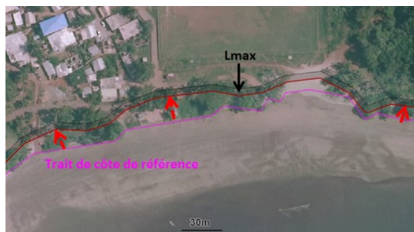
Espace tampon « Lmax » de 5m traduisant le recul consécutif au passage d'un événement exceptionnel
