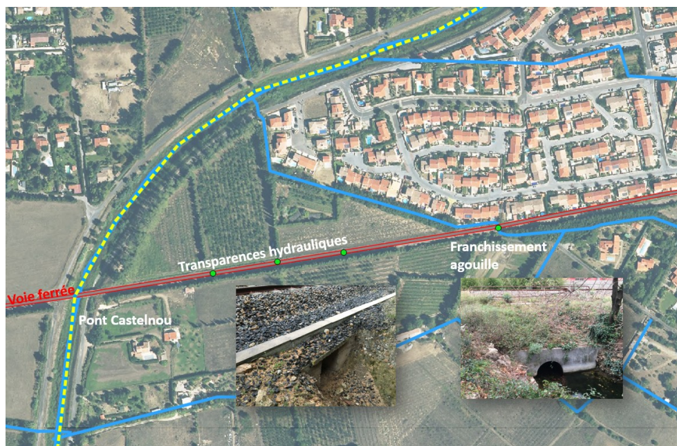
Illustration 20 : Ouvrages de transparence hydraulique de la voie ferrée (secteur commune du Soler)
