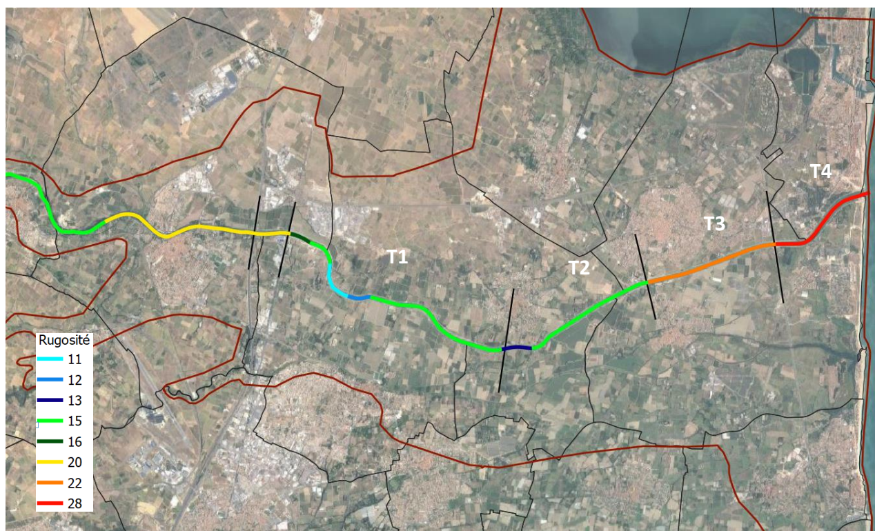
Rugosité 2D dans le lit mineur ( m^{1/3}/s ) – calage 2020
