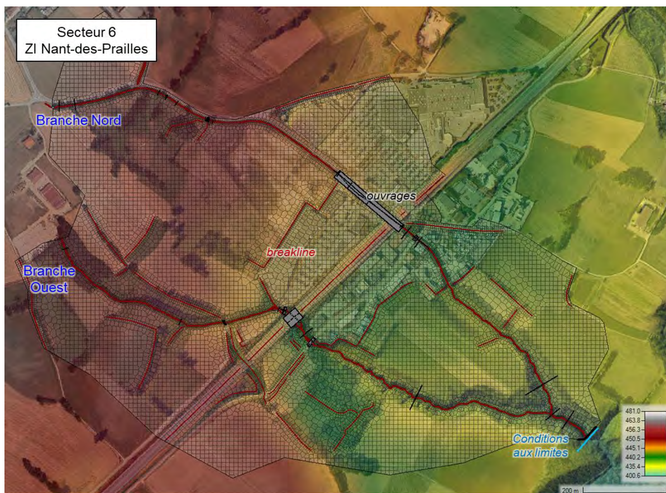
Figure 7 : Maillage du modèle hydraulique 2D de Ferney-Voltaire (Secteur 6)
