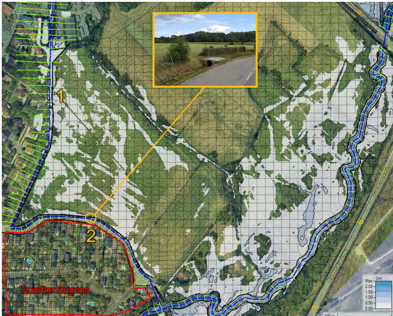
Figure 26 : Résultats des simulations hydrauliques 2024 : situation juste avant le débordement de l'Ouaf ( 1,3 \text{ m}^3/\text{s} injecté en entrée du modèle = Q_{\text{pointe 10 ans}} )
