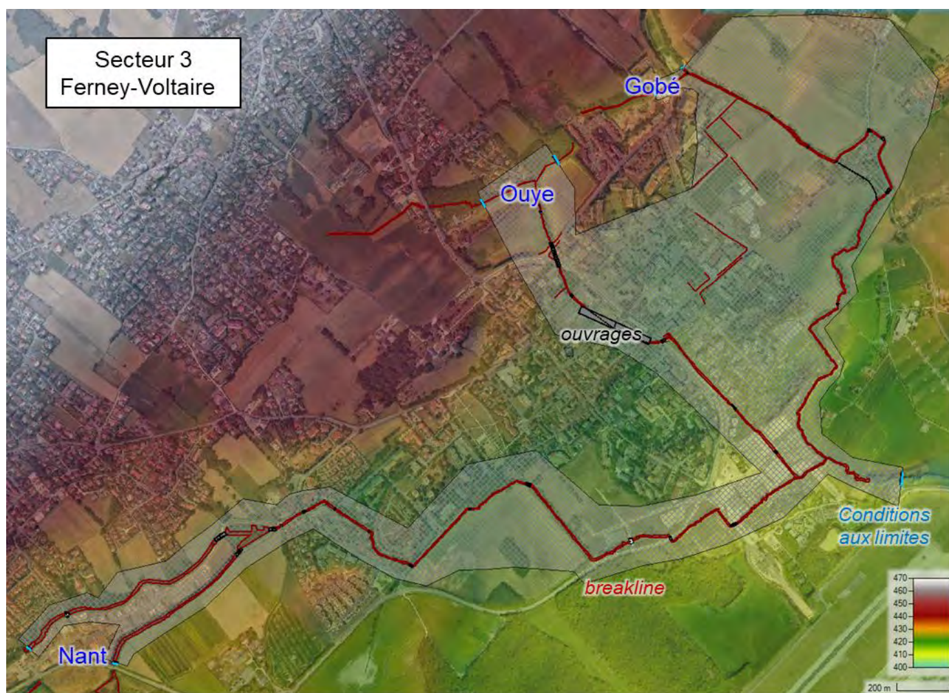
Figure 6 : Maillage du modèle hydraulique 2D de Ferney-Voltaire (Secteur 3)
