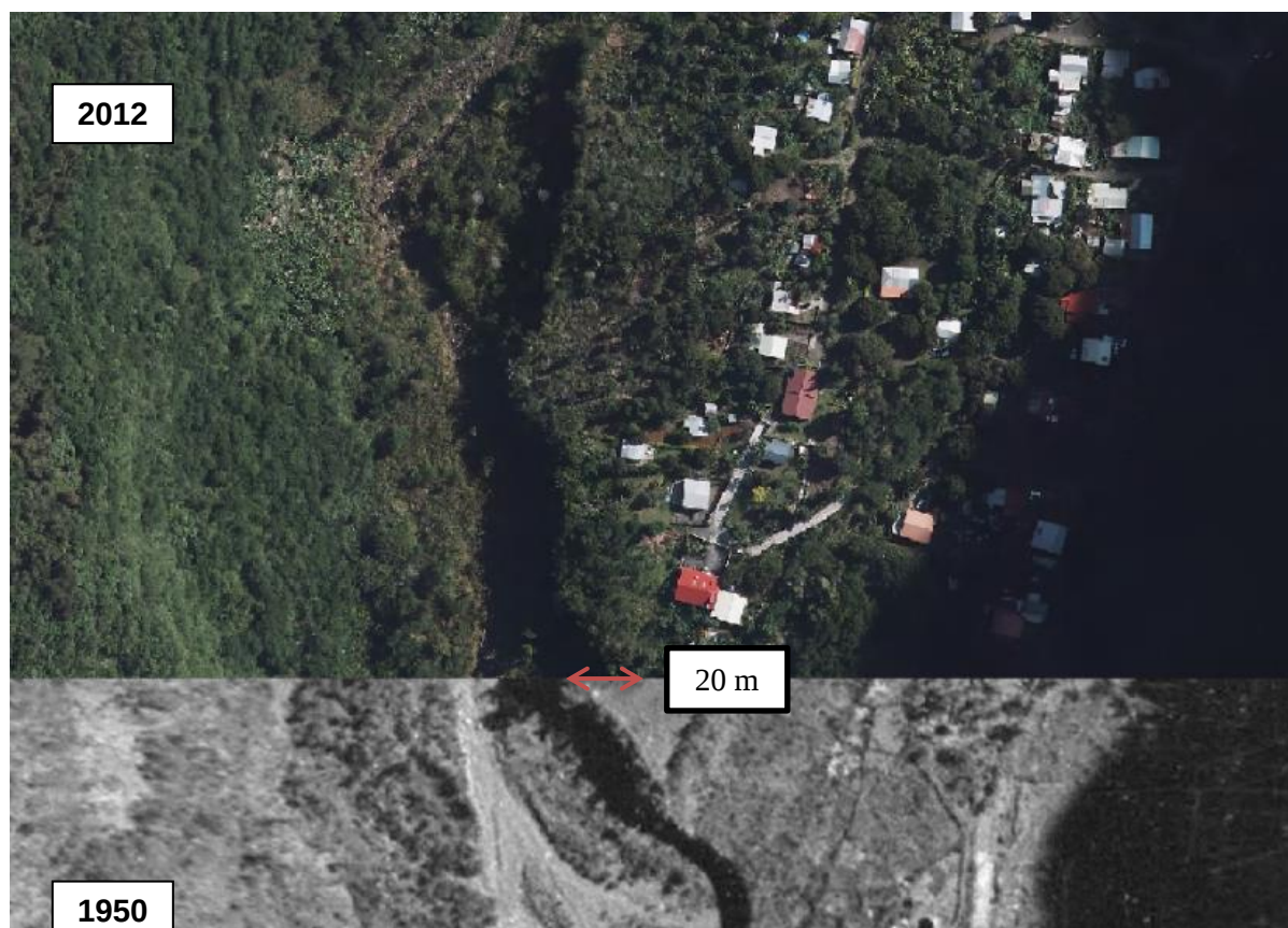
Figure 41 : Recul des berges de la ravine de Grand Coude observé à l'ouest du village de Grand Galet en comparant l'orthophotographie de 1950 et celle de 2012 (source : orthophotos © IGN)
