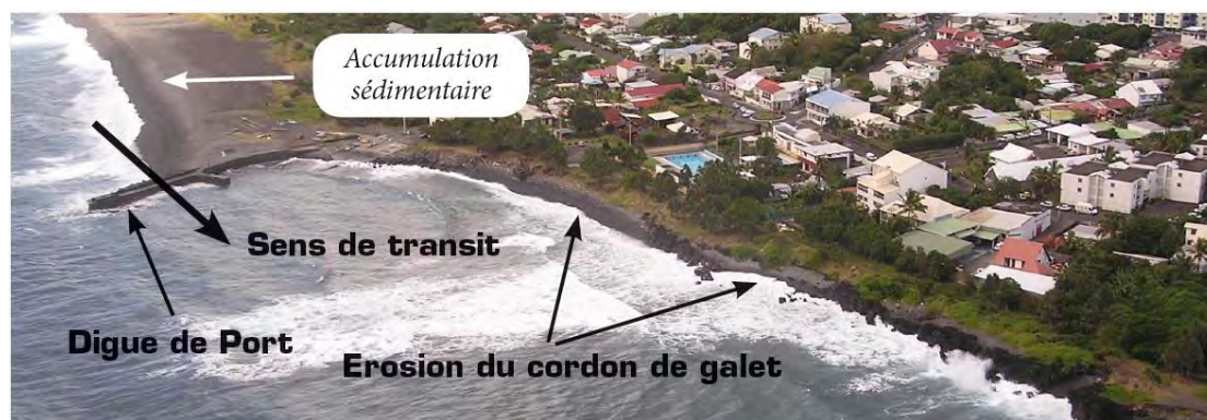
Figure 19 - Digue bloquant le transit sédimentaire à Saint-Benoît (De La Torre et al, 2012)
