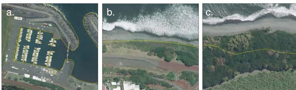
Figure 31 – Exemple de définition du trait de côte suivant les morphotypes du littoral de Ste-Marie : a. limite en pied d'aménagement (orthophoto IGN© 2011); b. limite de végétation (orthophoto IGN© 2011); c. limite de haut de versant (sur la base de Lito3D©IGN)
