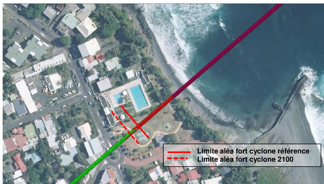
Figure 45 - Evènement de référence « cyclone Dina » : Limites de l'aléa fort le long du profil 2 pour les scénarios « référence » et « 2100 » pour 1 heure simulée – Vue en plan (Fond orthophotographie 2011, IGN©)
