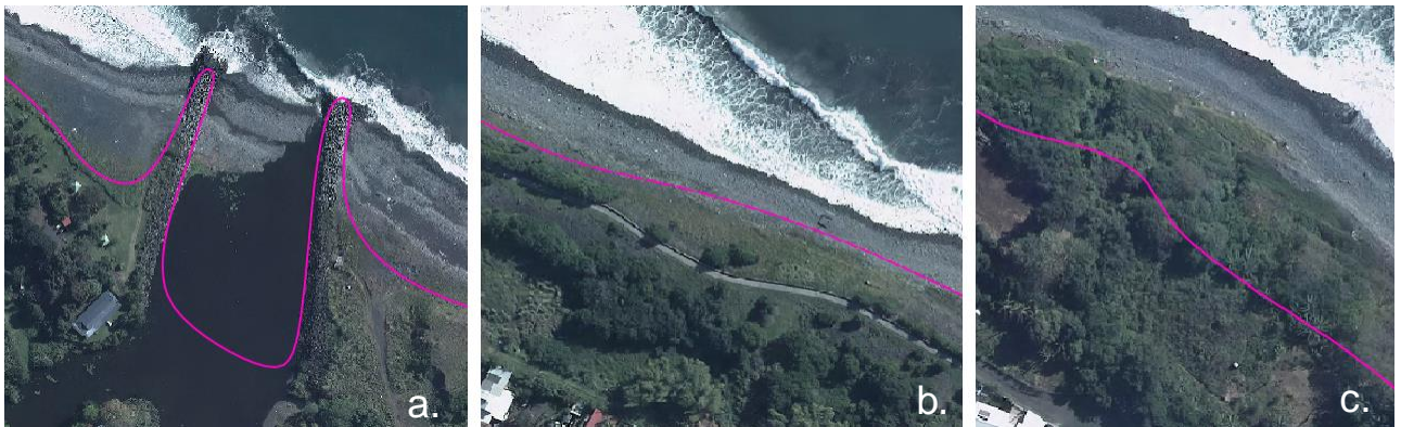
Figure 31 – Exemple de définition du trait de côte suivant les morphotypes du littoral de la côte nord-est: a. limite en pied d'aménagement (ortho 2011); b. limite de végétation (ortho 2011); c. limite de haut de versant (lidar)
