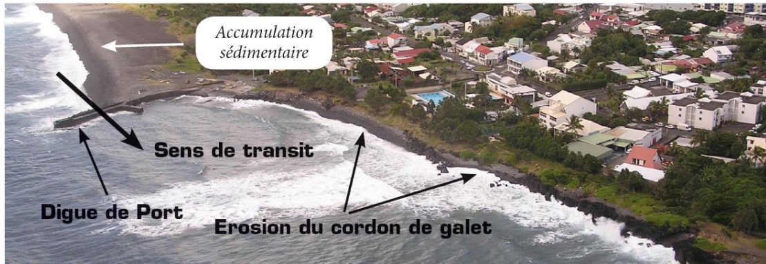
Figure 19 – Exemple de digue bloquant le transit sédimentaire à Saint-Benoît (De La Torre et al, 2012)
