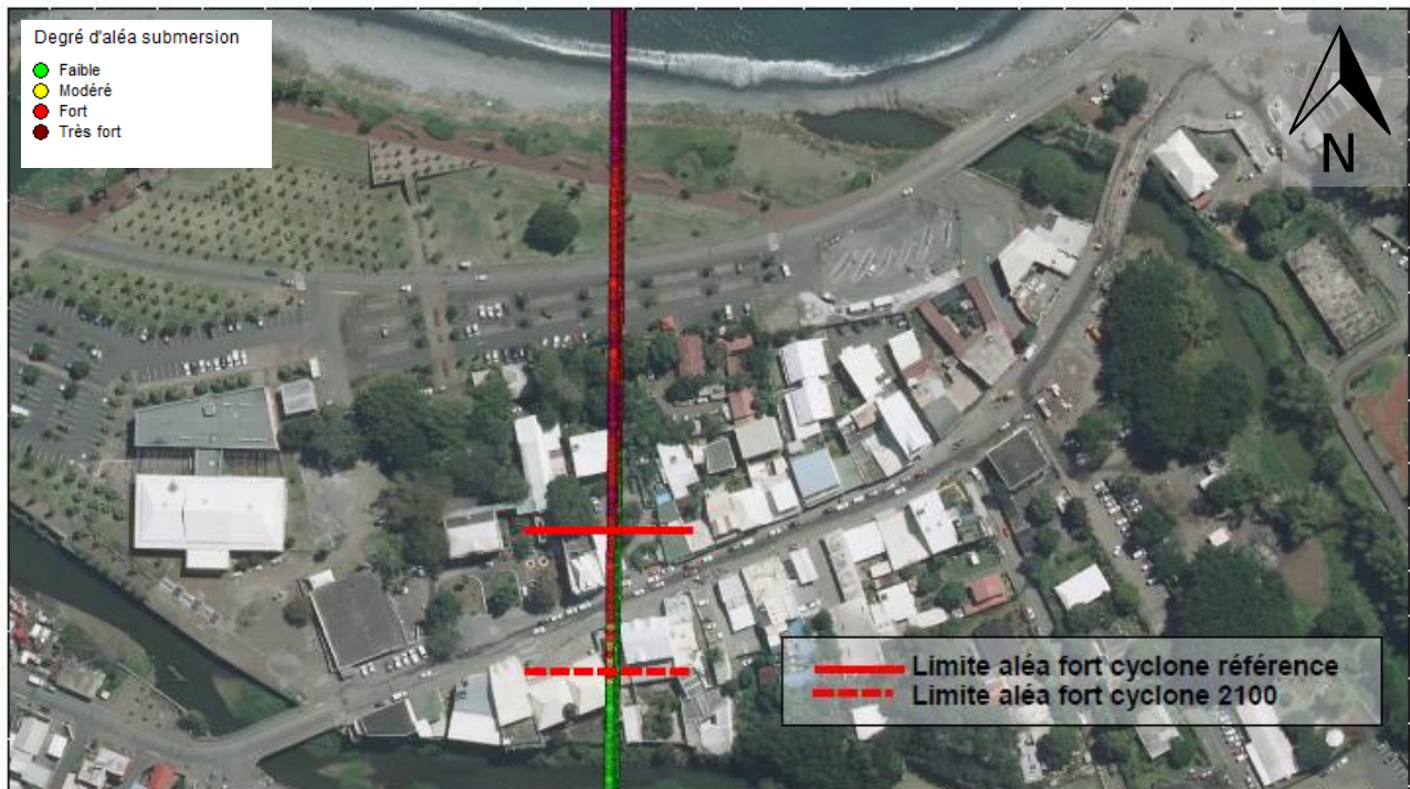
Figure 50 : Evènement de référence « cyclone Dina » : Limites de l'aléa fort le long du profil 2.2 pour les scénarios « référence » et « 2100 » pour 1 heure simulée – Vue en plan (Fond orthophotographie 2011, IGN©)
