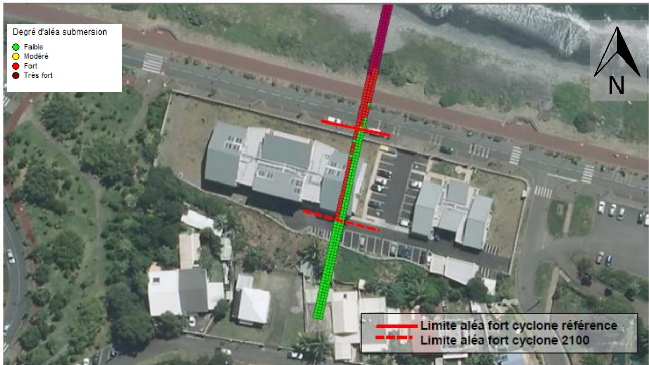
Figure 48 - Evènement de référence « cyclone Dina » : Limites de l'aléa fort le long du profil 2.1 pour les scénarios « référence » et « 2100 » pour 1 heure simulée – Vue en plan (Fond orthophotographie 2011, IGN©))
