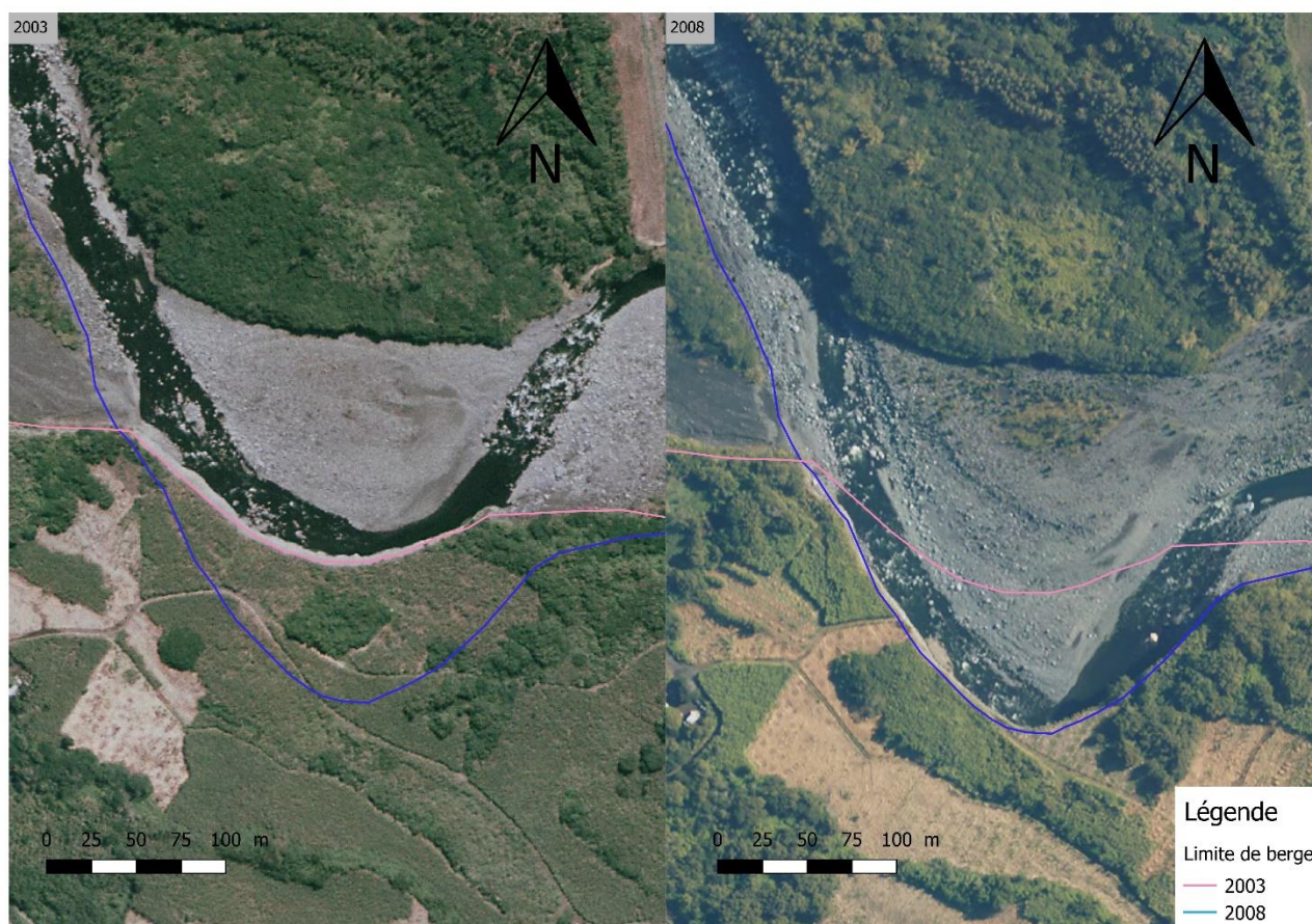
Figure 16 : Recul de la limite de berge entre 2003 et 2008 en rive droite du lit de la rivière du Mât
