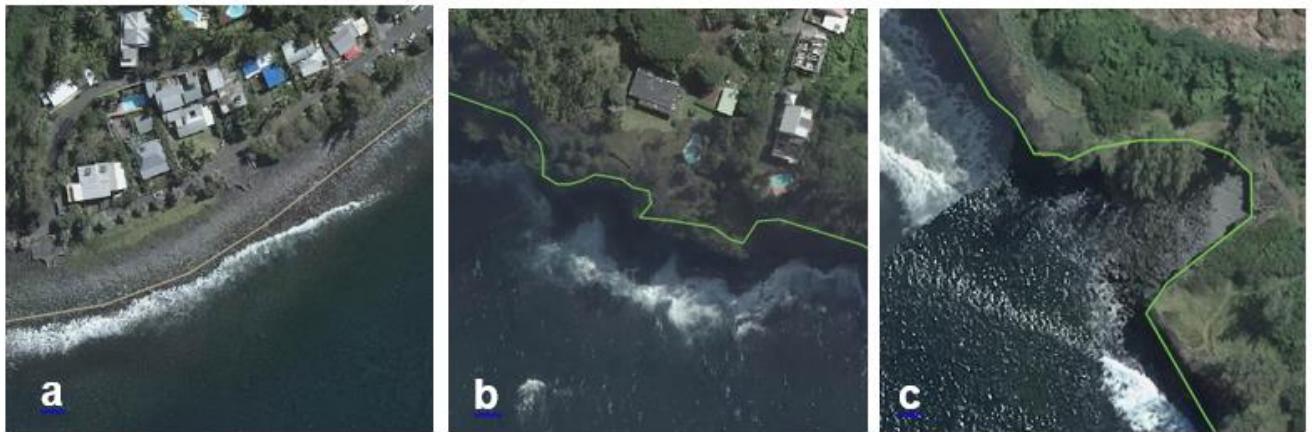
Figure 29 - Exemple de définition du trait de côte suivant les morphotypes du littoral : a. limite de jet de rive ; b. rupture de pente ; c. limite de crête de falaise (Fond orthophotographique ©IGN, 2017)
