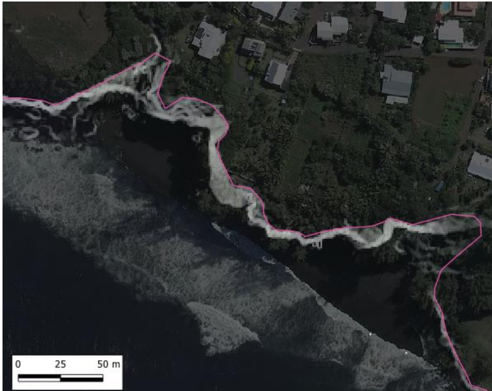
Figure 34 : Rupture de pente mise en évidence à partir du MNT Litto3D de l'IGN, utilisée comme trait de côte de référence pour la projection du Lr (2008)
