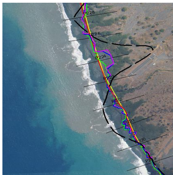
Figure 34 : Exemple d'artefact (en pointillé noir trait de côte 100Tx en « dent de scie », en couleurs les différents traits de côte historiques) généré par les profils au sud de la Rivière des Galets sur la commune de St Paul ©IGN
