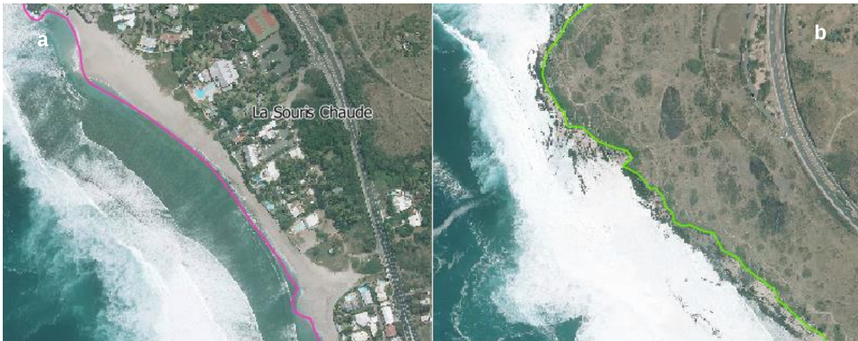
Figure 31 : Exemple de définition du trait de côte suivant les morphotypes du littoral de Trois-Bassins (a : Limite basse du littoral, b : limite haute du littoral) ©IGN
