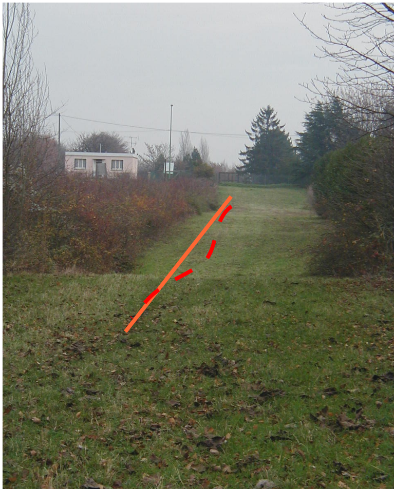
Figure n°12: Exemple d'affaissement de terrain dans le cas de la dissolution de niveaux résiduels de gypse sub-affleurant – Butte de Vaujours en Seine-Saint-Denis (photographie source CETE IF)
