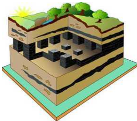
Figure 4 : Schéma du principe d'une exploitation par chambres et piliers abandonnés ( paca.developpement-durable.gouv.fr )
