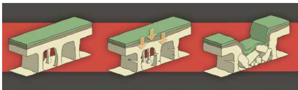
Figure 15 : Représentation schématique d'un effondrement localisé par rupture de plusieurs piliers (source : Ineris)
