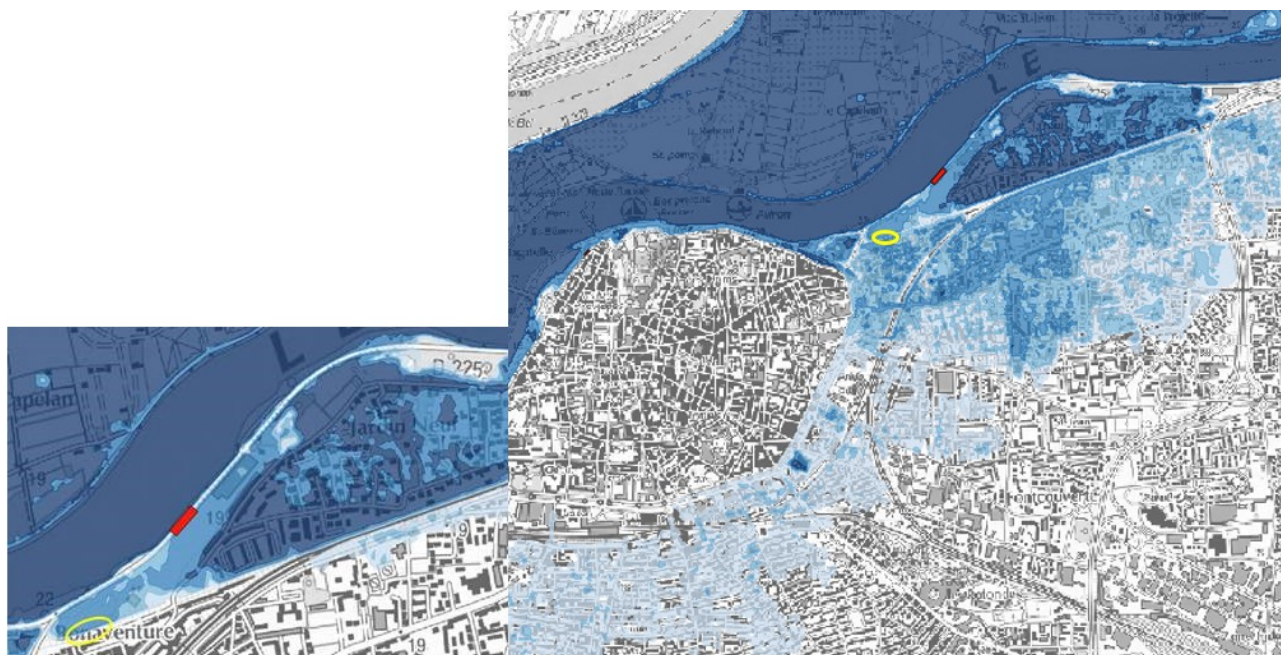
Localisation de la brèche potentielle dans la digue de Bonaventure (en jaune)
