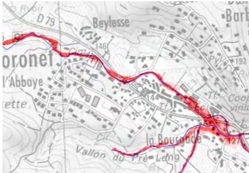
Figure 24 : Hauteurs d'eau et vitesse d'écoulement - La Gasquette, depuis l'amont de la zone urbanisée jusqu'au pont de la RD79
