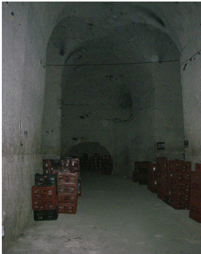
photo 1: Carrière de craie exploitée par piliers tournés (cliché IGC – Le Port Marly)
