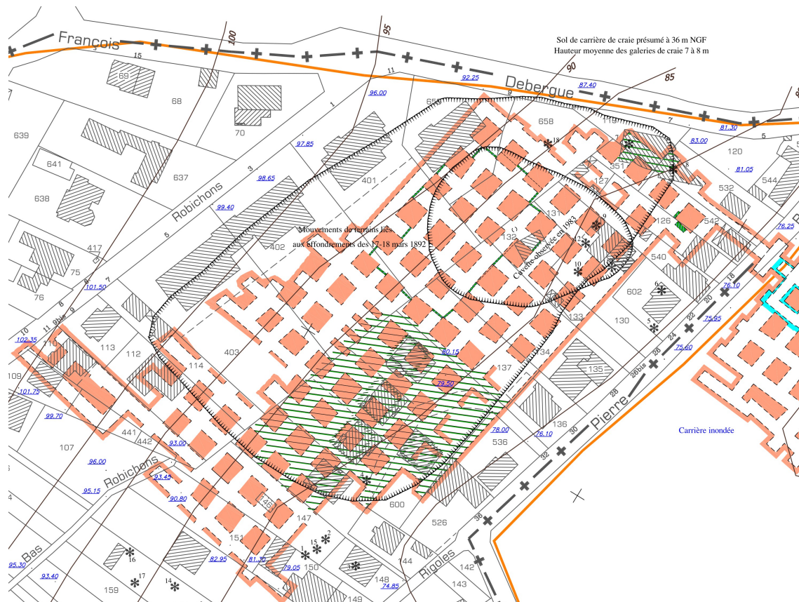
Figure 4: Extrait de l'atlas des carrières souterraines – La Celle-Saint-Cloud_AP (secteur des Robichons)
