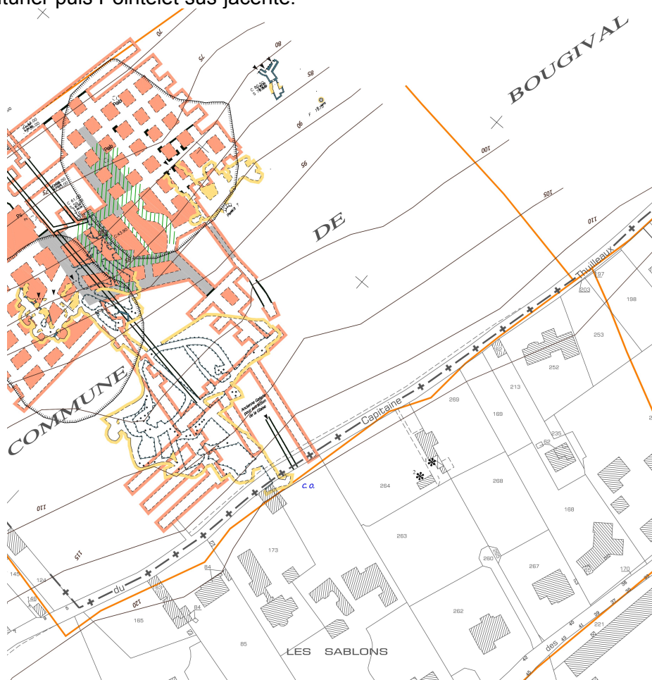
Figure 5: Extrait de l'atlas des carrières souterraines – La Celle-Saint-Cloud_AC (secteur des Sablons)
