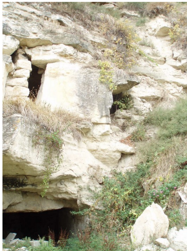
Photo 7 : Exemple d'exploitation de deux niveaux superposés
