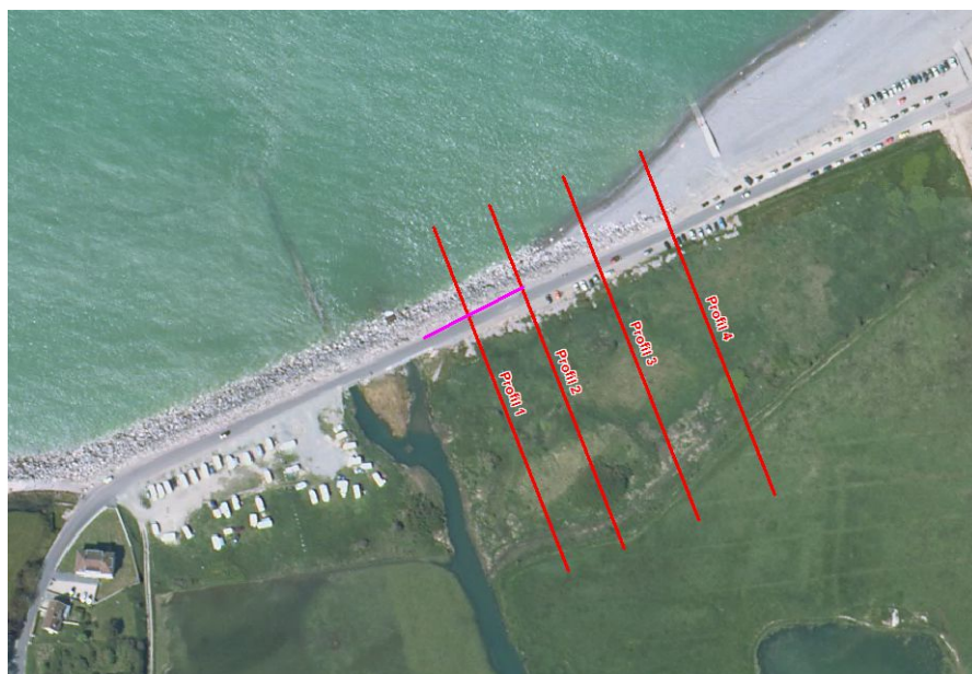
Figure 17 : tronçon de digue proposé pour la brèche
