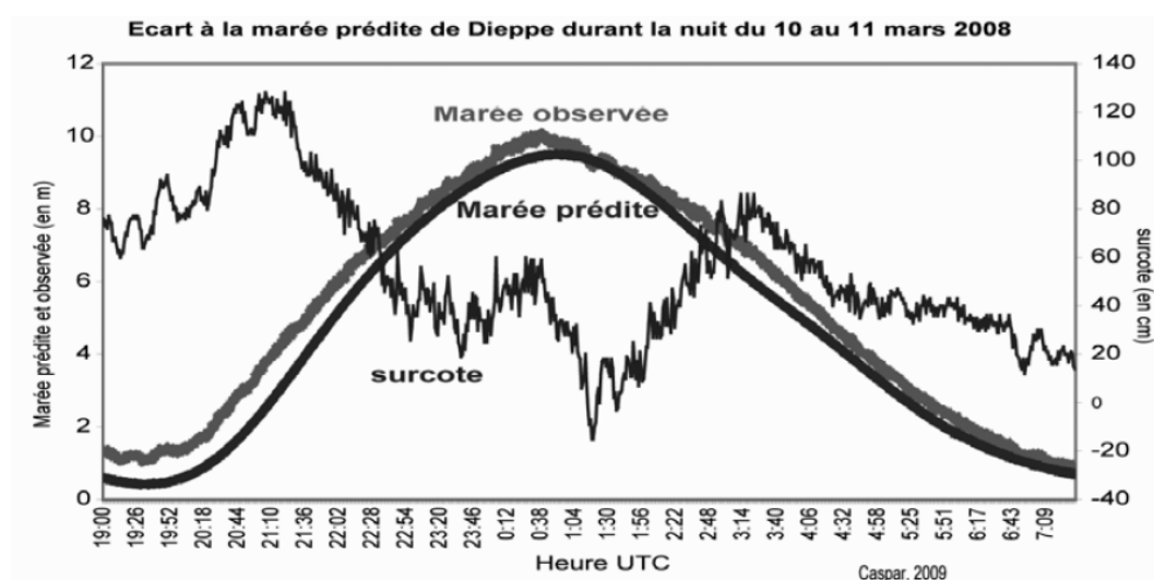
Figure 33 : Surcote à Dieppe lors de la tempête du 10 au 11 mars 2008 ; données SHOM et DDE
