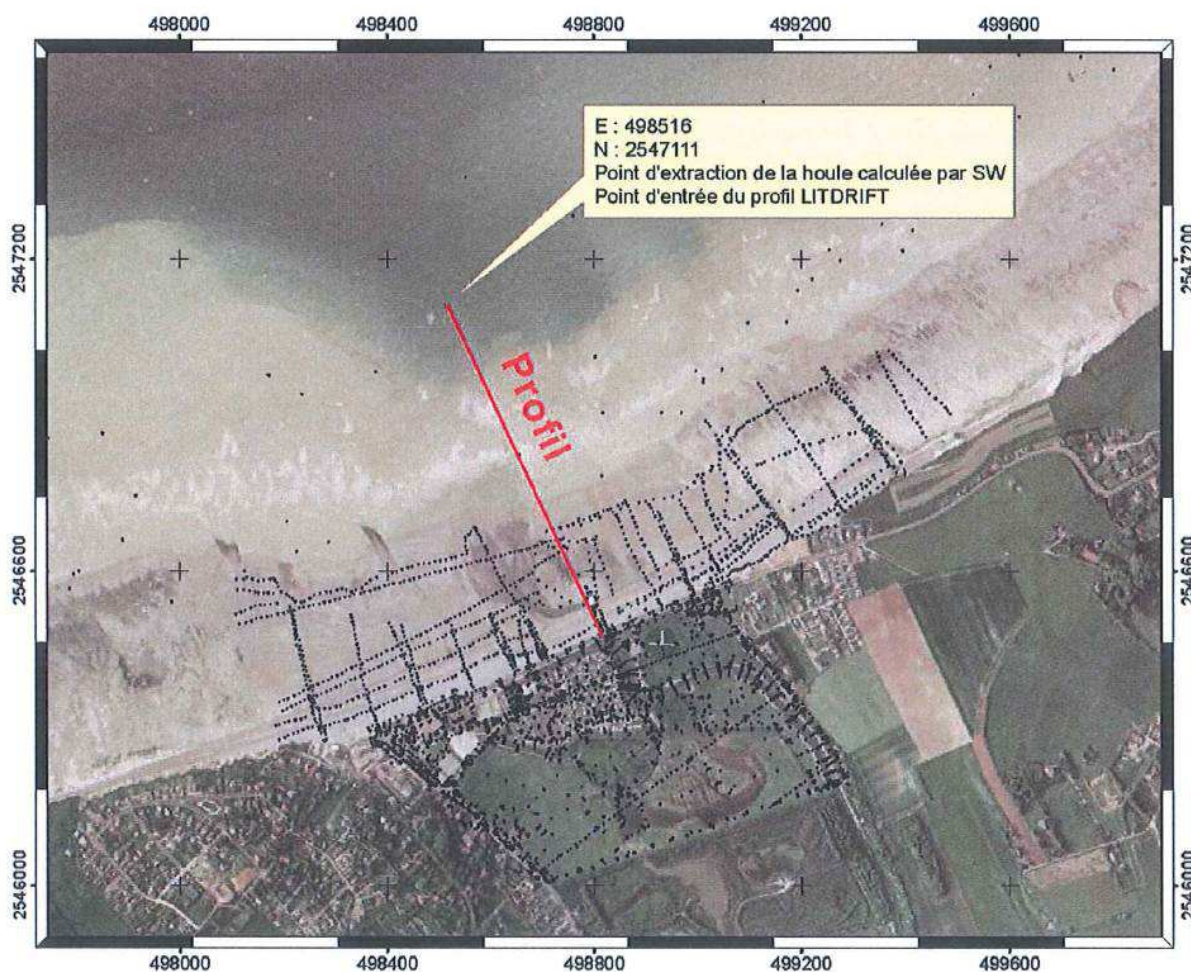
Figure 35 : Position du profil de plage devant l'épis buse pour le calcul du setup et du point d'extraction des données de houle (DHI, 2008)
