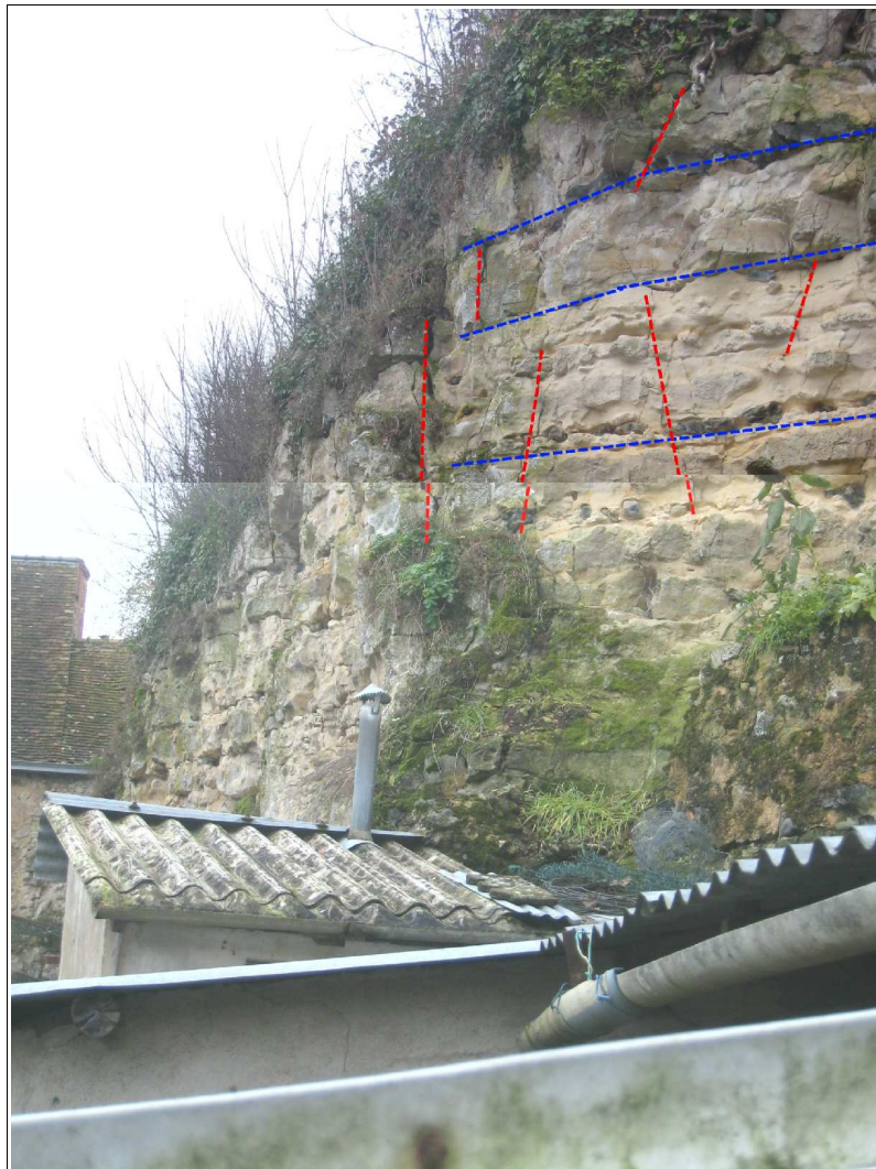
Figure 23 : Discontinuités visibles sur le coteau à Parcé sur Sarthe : Stratification du calcaire (tiret bleu), diaclases (tiret rouge)
