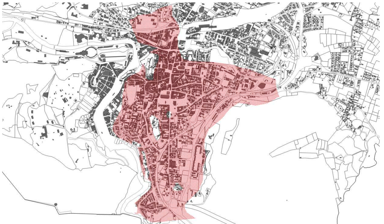
Figure 11 : zone géotechnique « Centre Ville »' faisant partie de la classe de sol 1, avec une qualification de portance de sol de fondation faible à moyenne.
