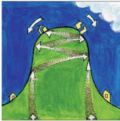
Figure 8 : Principe des effets de site topographiques
