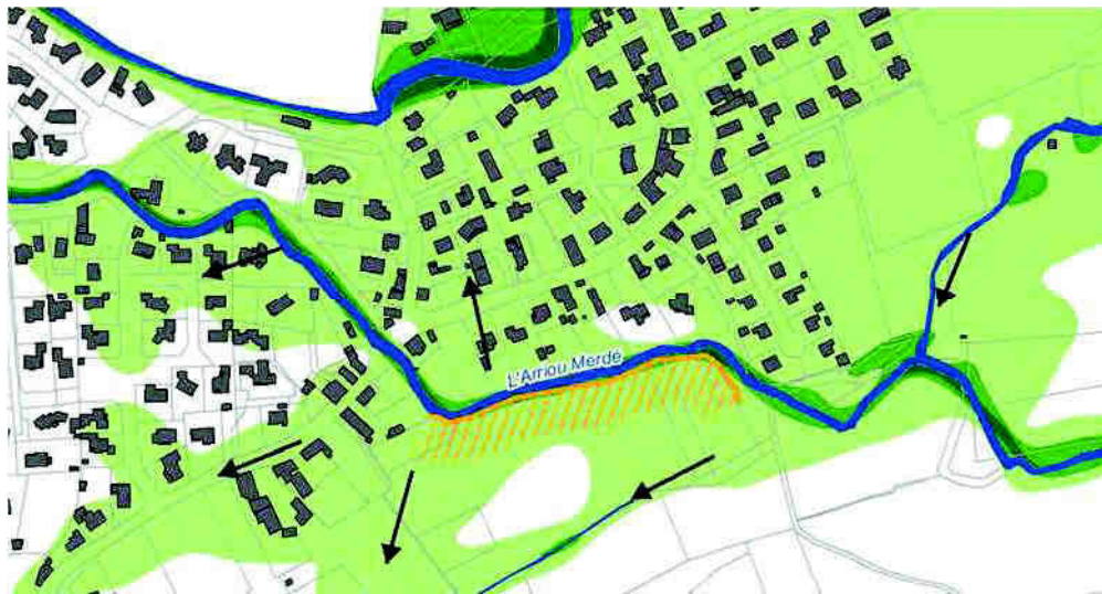
Figure 34 : Exemple de bande de sécurité (hachurage orange)
