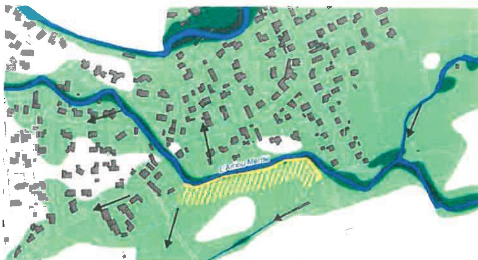
Figure 34 : Exemple de bande de sécurité (hachurage orange)
