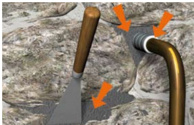
Situation après travaux de colmatage
