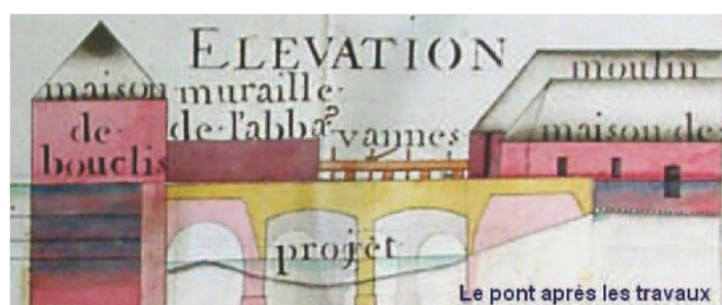
Le pont suite aux travaux aux reprofilages entrepris en 1758. Le pont est rehaussé avec des ouvertures de 3 pieds plus hautes que les anciennes
