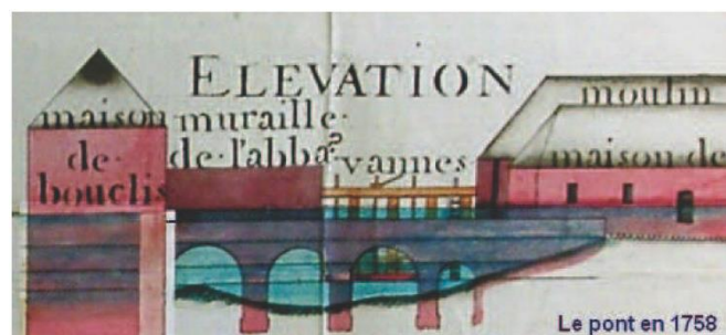
Le pont d'Haspres avant 1758, mis en charge lors de la crue de février 1757 ce qui entraîne l'inondation des quartiers amont
