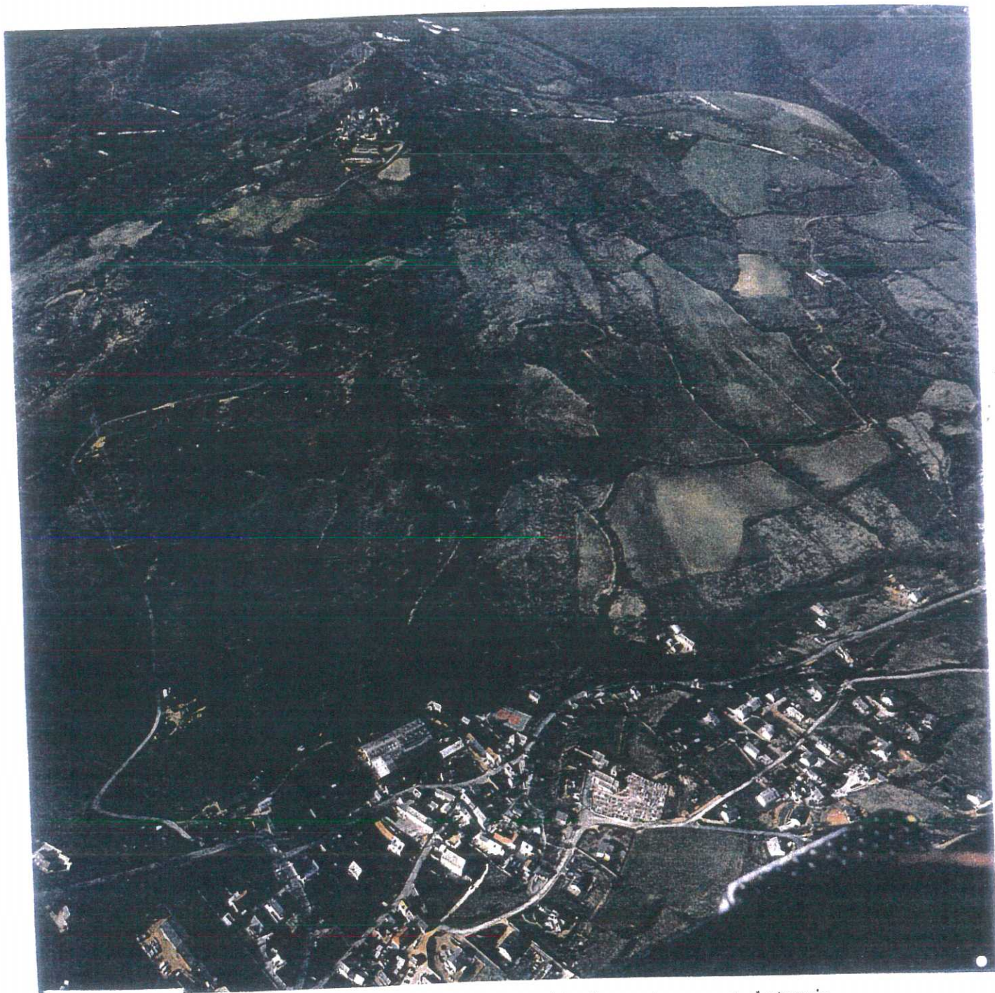
Versant Ouest de BARJAC ou l'on distingue bien les moutonnements du terrain caractéristiques des glissements
