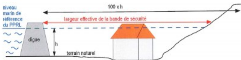
Calcul de la bande de précaution à l'arrière d'un ouvrage de protection.
