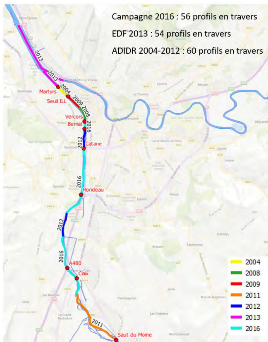
Figure 9 : Données topographiques utilisées pour la construction du lit mineur (Saut du Moine – Barrage de Saint-Égrève)
