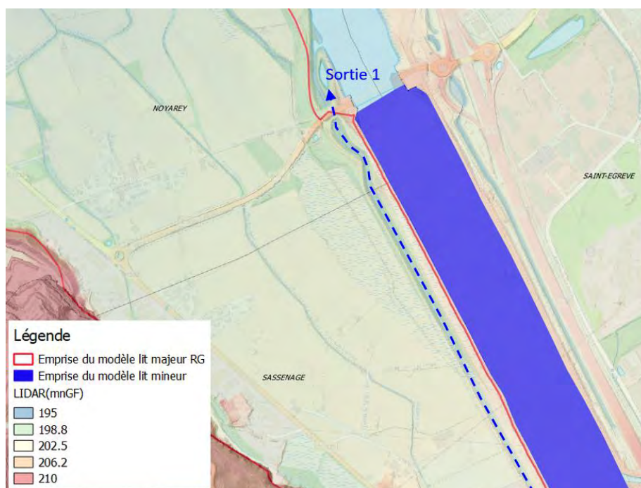
Figure 34 : Condition aval 1 – Modèle rive gauche
