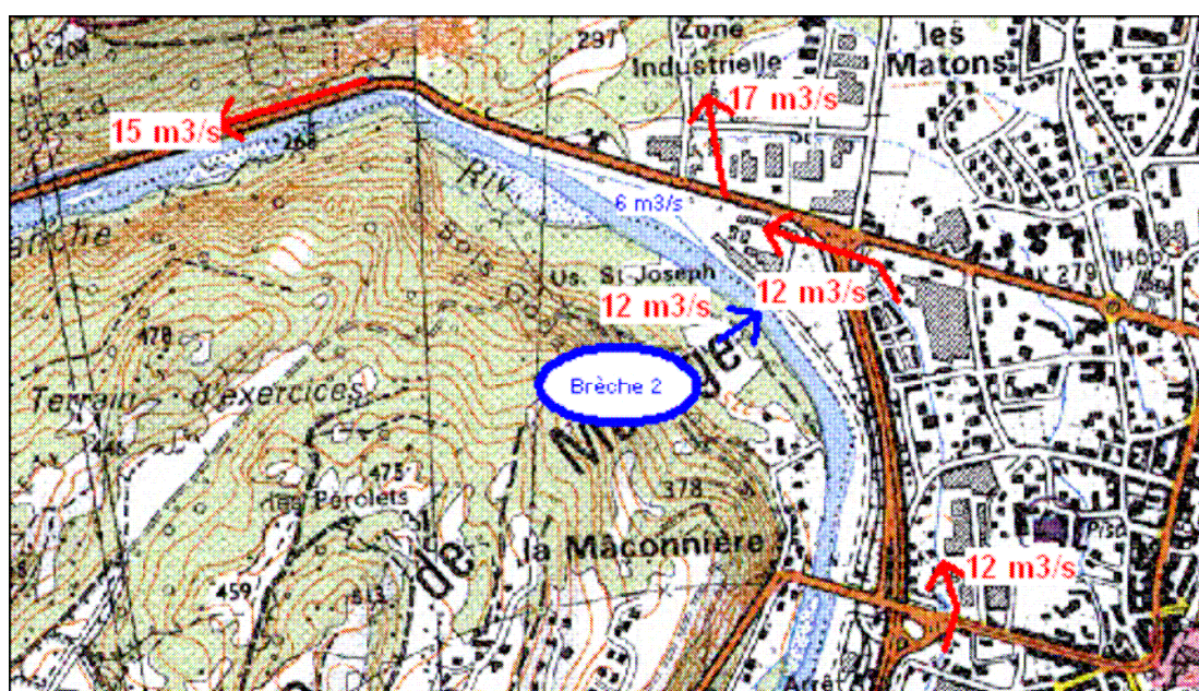
Figure 22 : Description des écoulements du scénario 2
