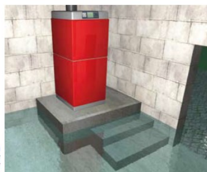
Protection d'un équipement de chauffage par surélévation.
