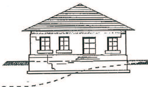
Figure 13 : Désordres liés au retrait gonflement des argiles. Source : extrait de Sécheresse et construction ; guide de prévention, 1993.
