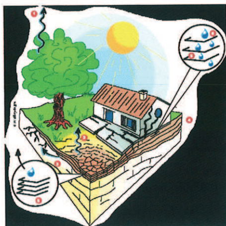
Figure 12 : Schéma de principe du retrait gonflement argileux. Source BRGM.
