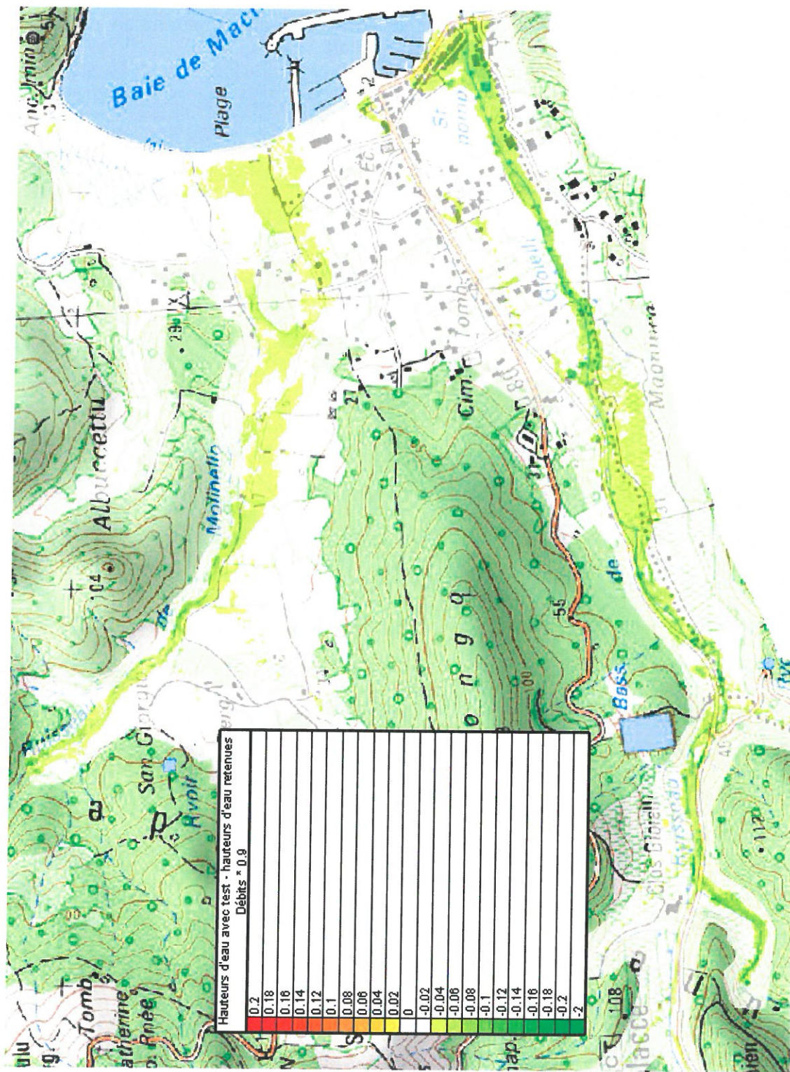
Figure 29 : Test de sensibilité sur les débits : diminution des débits retenus de 10 %
