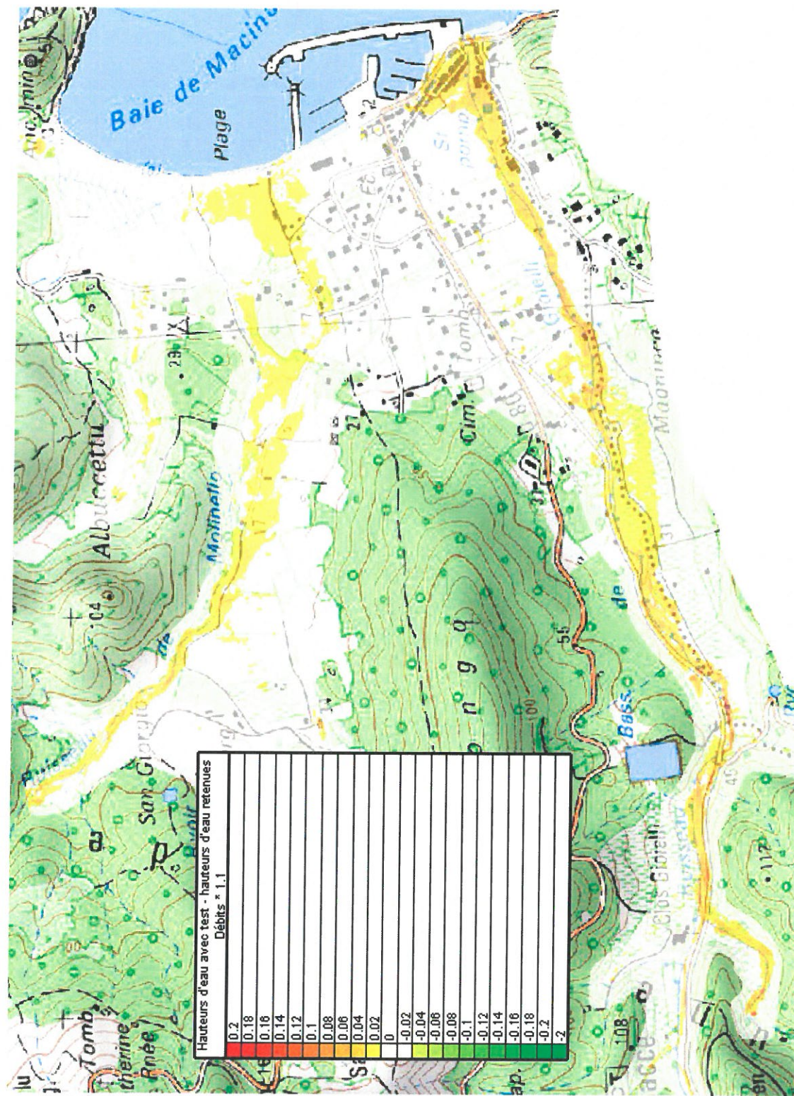
Figure 28 : Test de sensibilité sur les débits : augmentation des débits retenus de 10 %
