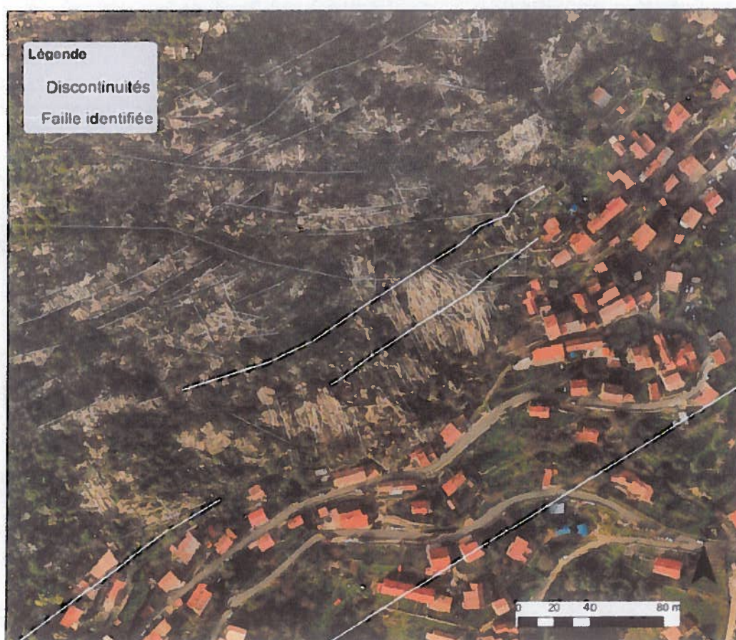
Figure 7: Zoom sur la zone du bourg illustrant le réseau de fractures (linéations) et failles
