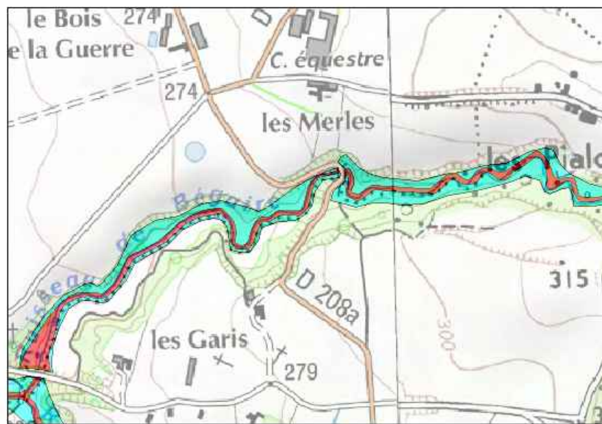
Exemple d'application de la méthode hydrogéomorphologique sur le ruisseau de Bégaire (ou Bionne, affluent de l'Ecoutay) entre les communes de Montvendre et La Baume Cornillane. Les lits mineur et moyen sont classés en aléa fort (rouge) et le lit majeur en aléa faible (bleu)
