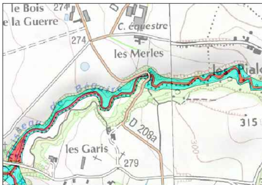
Exemple d'application de la méthode hydrogéomorphologique sur le ruisseau de Bégaire (ou Bionne, affluent de l'Écoutay) entre les communes de Montvendre et La Baume Cornillane. Les lits mineur et moyen sont classés en aléa fort (rouge) et le lit majeur en aléa faible (bleu)
