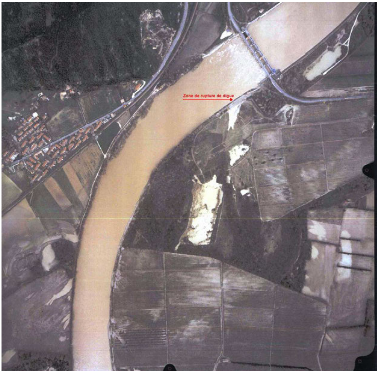
4 décembre 2003 – Rhône à l'aval du barrage de Donzère après début de ressuyage – à noter les traces de rupture de digue - (photo DIREN de bassin)
