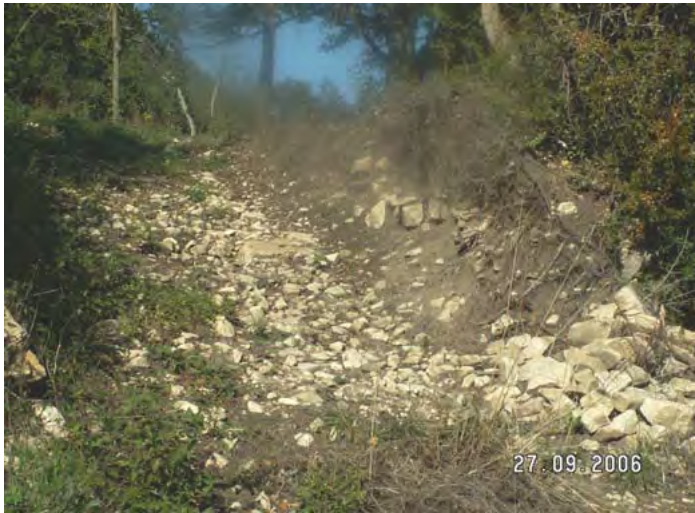
Eboulis de pente non consolidés constitués d'éléments plus ou moins anguleux, emballés dans une matrice limoneuse à argileuse plus ou moins abondante.
