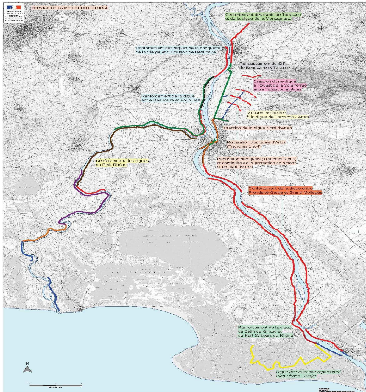
Figure 15 : Opérations du programme de sécurisation des ouvrages de protection
