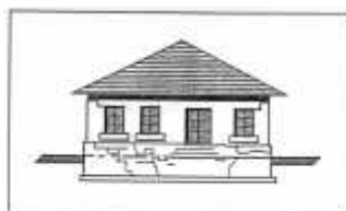
Figure n°2 : Désordres à l'ensemble du soubassement et de l'ossature
