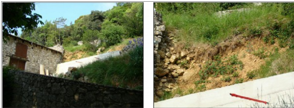
figure 61 : Mise en évidence de la lithologie peu compétente (marnes et colluvions) au niveau du hameau des Aliberts
