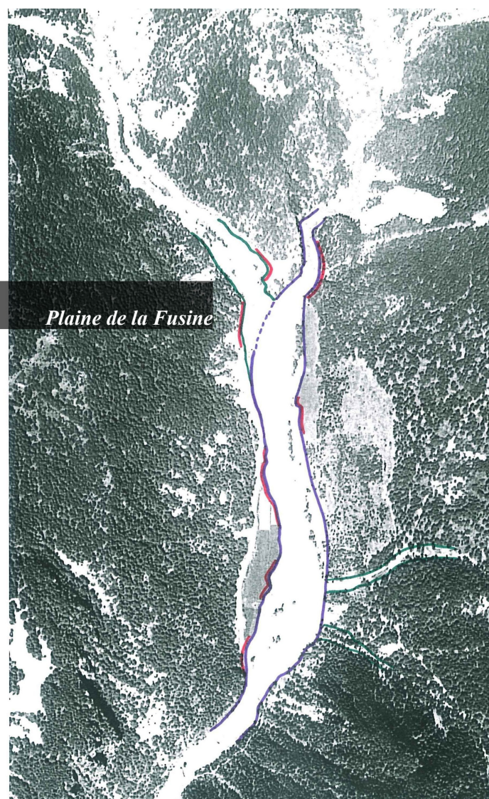
Photographies aériennes ci-dessus : extraits sur les zones affectées par les crues de juin 1957, avec l'extension maximale des crues du Guil et de l'Aigue Blanche (en bleu), des crues torrentielles (en vert), des secteurs érodés (en rouge).
