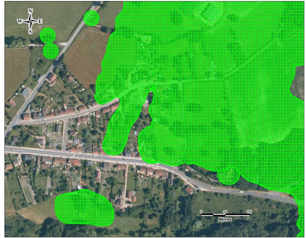
Figure 10 : Aléa effondrement localisé en 2018 dans le secteur Marceau à Doyet suite à sondages, réexamen et travaux de sécurisation
