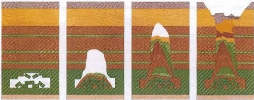
Figure 3 : Principes du phénomène de fontis
