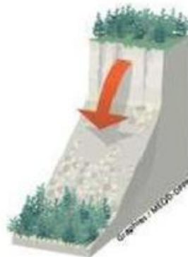
Principe des chutes de blocs et de l'érosion régressive
