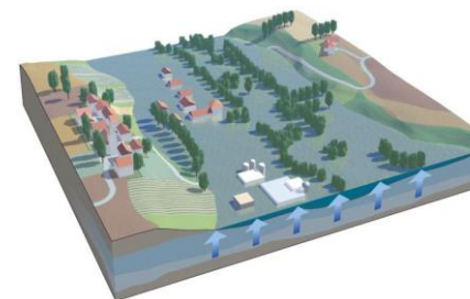
inondation de nappe
